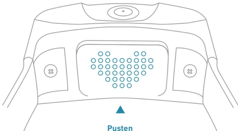
Prüfen Sie ob der Akku geladen und der Trainer eingeschaltet ist. Anschließend von hinten gegen den Sensor pusten, so dass der Trainer ein Sprühsignal ausgibt.
