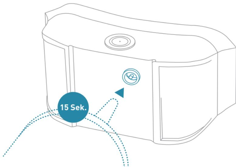
Der Antibell Spray Trainer Advance muss zum Befüllen mit Spray ausgeschaltet sein. Der Füllstutzen muss dazu vertikal auf das Einfüllventil angesetzt werden. Wenn der Füllstutzen richtig sitzt, mit leichtem Druck den Trainer für 15 Sekunden befüllen.
